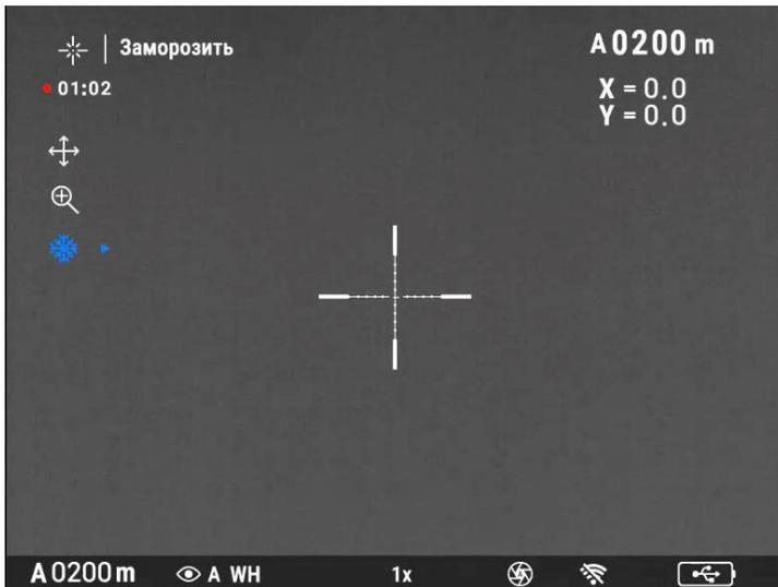
После завершения пристрелки на сетке прицела отобразятся стозначные цифры установленного вами расстояния: цифра 2 соответственно 200м, цифра 3 - 300м и т.д..
