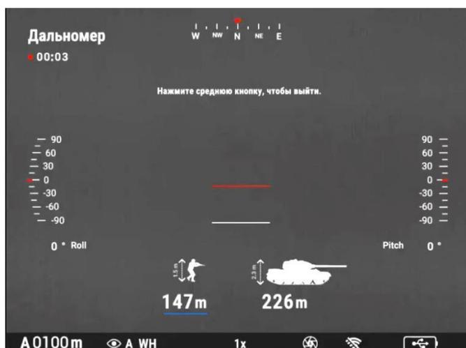
Расстояние до объекта отображается в течение 20 секунд в верхней части дисплея, а синяя риска с делениями на прицельной сетке указывает точку прицеливания соответственно. Шаг деления на синей рискке позволяют рассчитывать поправки по ветру. Шаг риски - 1 MOA.
